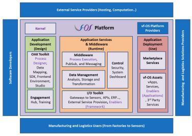
Figure 1. vf-OS Global Architecture Definition
